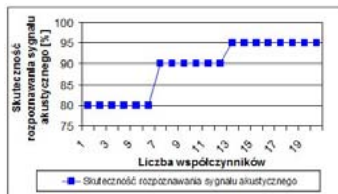
Rys. 4.24. Skuteczność rozpoznawania sygnału akustycznego przy zastosowaniu algorytmu wybierania amplitud dla częstotliwości 233, 887, 1260, 2286, 2566 Hz, LPCC i zmodyfikowanego klasyfikatora NM z metryką Euklidesa w zależności od liczby współczynników cepstralnych dla maszyny prądu stałego
