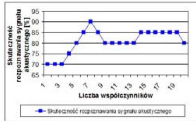
Rys. 4.19. Skuteczność rozpoznawania sygnału akustycznego przy zastosowaniu algorytmu wybierania amplitud dla częstotliwości 233, 887, 1260, 2286, 2566 Hz, LPC i zmodyfikowanego klasyfikatora NM z metryką Euklidesa w zależności od liczby współczynników filtra predykcji liniowej dla maszyny prądu stałego
